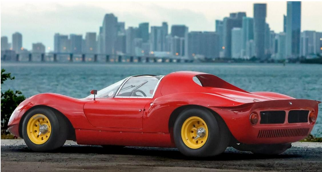
Die Tatsache, dass es sich bei diesem Auto mit Chassisnummer 032 um den allerletzten gebauten 206S und zugleich um eines von nur zwei Modellen mit der leistungsstärksten Evolution des Zweitliter-65°-V6-Motors (Tipo 233) mit 270 PS handelt, macht diesen Ferrari besonders begehrtesten. Es ist also sehr wahrscheinlich, dass zwischen dem 15. und 17. Februar einige „versiegelte Umschläge“ auf der Fußmatte von RM Sotheby's landen werden.
