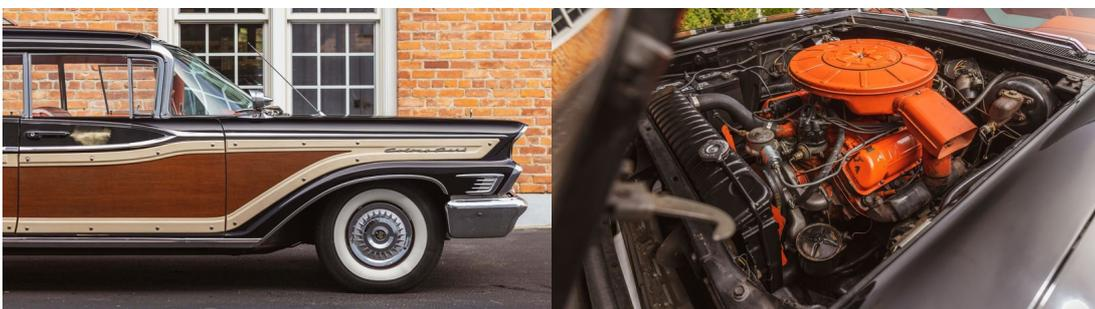
Dieser ganze in ein schillerndes Design verpackte Raum will natürlich gezogen werden. Das erledigt im Mercury ein 383-Kubikzoll-V8, der vom Werk aus mit gut 326 PS angegeben wurde, und mit einer Dreigang-Automatik gekoppelt wurde. Wie der Name schon verrät: Ein Cruiser für müheloses Reisen.
