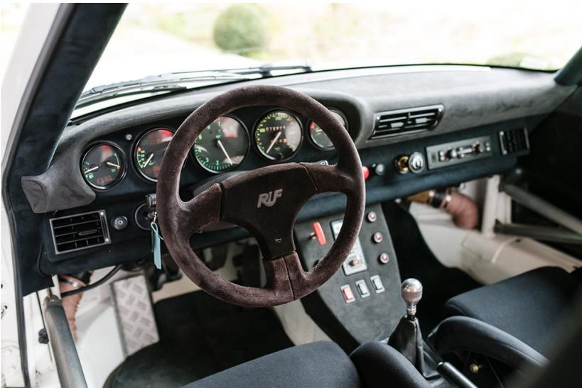
Takeyama meinte es mit seinem Ansinnen wirklich ernst. So verlangte er zusätzlich, dass die Heizungseinheit nach links gerückt werde, um schnellen und einfachen Zugriff auf den Turbo Boost Control zu haben, der sich verlockenderweise nur einen Fingerzeig entfernt von der Schnellentriegelung des RUF-Lenkrads befindet. Diese befindet sich - nicht minder wichtig - in Nähe des Zündungs-Trennschalters und verbundenen Feuersystems.□
