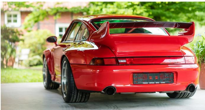
Der 3,6 Liter große Bi-Turbo des GT2 leistet 430 PS und treibt im Gegensatz zum allradgetriebenen 993 Turbo nur die Hinterachse an. Zur Gewichtsdiät (200 Kilo weniger) tragen Türen und Hauben aus Aluminium, Scheiben aus Dünnglas, der Entfall der hinteren Sitzanlage sowie ultraleichte Magnesium-Felgen von Speedline bei. Folge sind irre Beschleunigungszeiten von 4,4 Sekunden von 0 auf 100 km/h und eine Spitze von 295 km/h.
