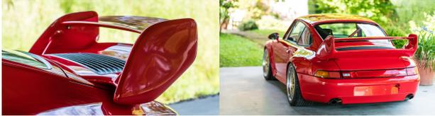
Jetzt geht es mit uns durch. Der [Cup 3.8 RSR](#) basiert auf dem 993 Cup – doch mit einer rennsporttauglichen Aufhängung in Kugelgelenken und GT2-Kotflügelverkleidungen. Er wurde als aus dem Stand startbereiter 24-Stunden-Langstreckenrenner konzipiert – daher auch der Matter Käfig, die Alu-Haube, die einstellbaren Bilstein-Dämpfer, die Domstreben, der Frontspoiler und der verstellbare Heckflügel.
