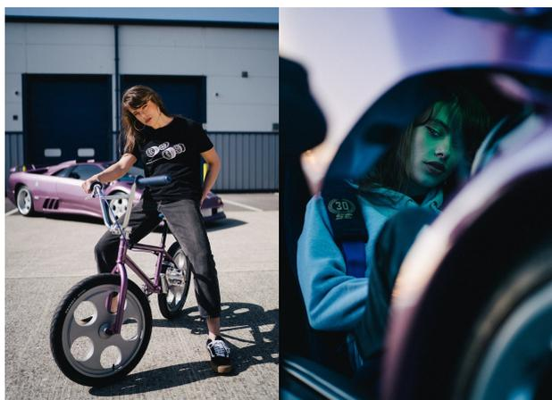
Die Felgen im Telefonwählscheiben-Design sind die wirklich besonderen Komponenten des Projekts. Sie sind definitiv keine Leichtbauteile, sondern per CNC aus dem vollen Aluminium gefräst und wurden dann silber lackiert, um den Leichtmetall-Magnesium-Rädern von O.Z. zu entsprechen.
