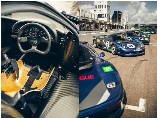
Die Leistung war schlicht und einfach umwerfend – die 450 PS des V12 katapultierten den XJR-15 in 3,9 Sekunden von 0 auf 100 km/h; je nach Übersetzung endete der Vortrieb erst bei 305 km/h. Das Handling war laut Zeitzeugen speziell beim Einsatz auf der Rennstrecke nicht unbedingt das Gelbe vom Ei – es mangelte an Anpressdruck auf der Hinterachse.
