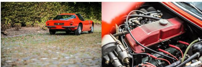
Statt des Small Block-V8-Chevy des 5300 GT trieb ein bescheidener, doch robuster 1,9-Liter-Motor von Opel mit 110 PS den GT Europa an. Installiert war er als
