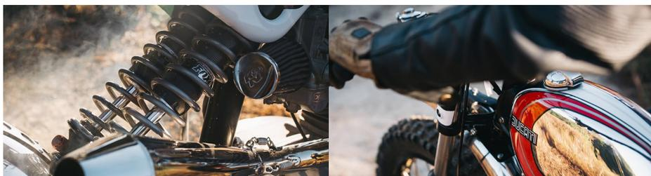
Das Dirt Bike heißt „Super Duc“ und folgt auf die zuvor ebenfalls bei [Fuller Moto](#) gebaute „Dirty Duc“. Beide basieren auf einer Ducati 250 Scrambler aus den 1960er-Jahren und wurden von Hand komplett neu aufgebaut. Neben dem Einzylindermotor teilen sich die Zwillinge das mittig angebrachte Paar Stoßdämpfer, klassische Ceriani-Vordergabeln und speziell geformte Blenden für die LED-Scheinwerfer. Die Farbgebung ist eine Referenz an die italienischen Wurzeln Ducatis.
