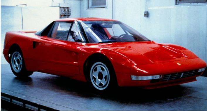
Der Ferrari FF war der erste Sportwagen aus Maranello mit Allradantrieb? Nicht ganz: Bereits 1987 hatten die Ingenieure mit dem Ferrari 408 4RM einen komplexen, hydraulischen Allradantrieb getestet. Doch der Prototyp sah nicht nur gruselig aus, auch die Technik konnte nicht überzeugen. Nur zwei Exemplare wurden gebaut, eines kann in der Galleria Ferrari begutachtet werden.
