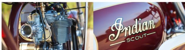
Ziel war es, dem Motorrad den Stil der 60er und 70er zu verleihen – jenen Look, den die Rennmaschinen dieser Zeit trugen. Der Originalmotor wurde neu aufgebaut und der Hubraum auf 500 Kubikzentimeter erweitert. Der Rahmen erhielt eine handgefertigte Verkleidung aus Aluminium, die teilweise nur mit Klarlack lackiert wurde.
