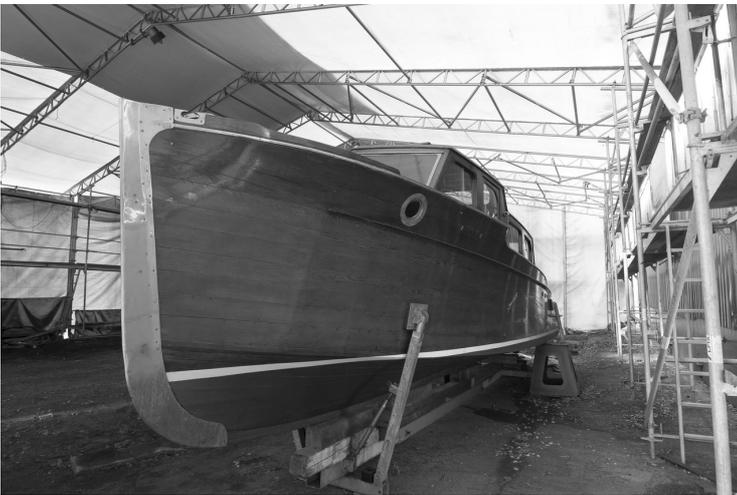
Ebenfalls bei John Faul lief die 9,00 Meter lange "Tom II" vom Stapel. Allerdings unter dem Namen "SwissCraft" - einem Namen, den sich die Werft in den 1940er-Jahren sicherte, um der Konkurrenz aus den USA etwas entgegenzuhalten und sogar selbst auf diesem Markt Fuß zu fassen. Angetrieben wird der in Kraweelbauweise gefertigte Holzbootklassiker von einem Ford-V8 mit 90 Pferdestärken. Gebaut wurde "Tom II" in den 1940er-Jahren.
