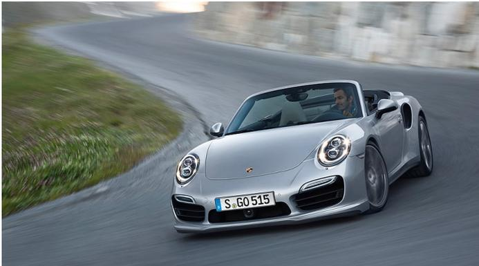
Auch optisch gleicht das Cabriolet dem Coupé: Im geschlossenen Zustand ermöglicht das Porsche-Flächenspiegelverdeck mit Leichtbaurahmen aus Magnesium die fließende Coupélinie. Das Dach lässt sich in 13 Sekunden und bis zu einer Geschwindigkeit von 50 km/h öffnen und schließen.
