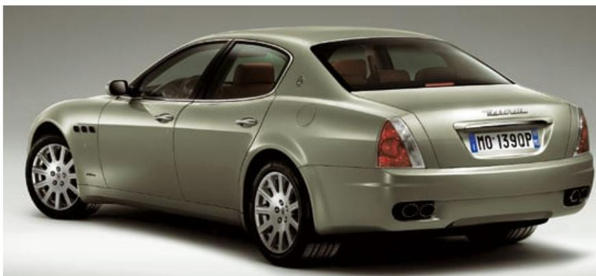
Neben Design von Pininfarina bietet der Quattroporte einen 4.2-Liter-V8 Front-Mittel-Motor, der mit dem Transaxle-System Sechsganggetriebes eine ideale Achslastverteilung von 46:54 Prozent zwischen Vorder- und Hinterachse erreicht. Dabei leistet der Leichtmetall-Motor bei 7000/min satte 400 PS. Das maximale Drehmoment: 451 Newtonmeter bei 4500/min.
