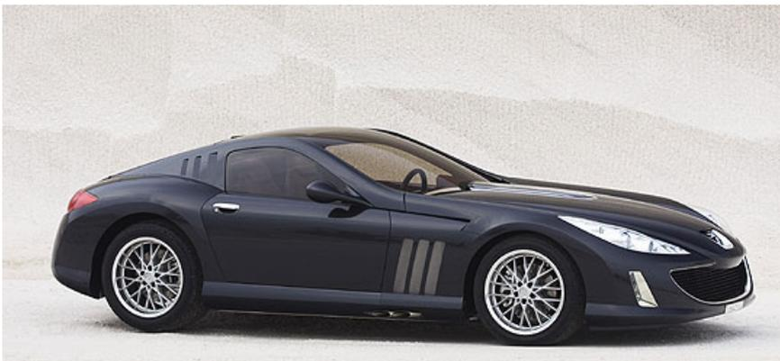
Die 4,37 Meter lange, 1,88 Meter breite und 1,21 Meter hohe Karosserie des 907 basiert auf einem Carbon-Monocoque und birgt zahlreiche Designmerkmale, wie beispielsweise ein gläsernes Dach, das nahtlos mit der Windschutzscheibe verbunden wurde. Große Kiemer zieren die vorderen Kotflügel und die B-Säule; aus den Türschwelleren ragen rechts und links Doppel-Auspuffendrohre heraus. Die weiten Radhäuser füllen Feinspeichenräder im 18-Zoll-Format und Reifen der Größen 275/40 vorn und 345/35 hinten.
