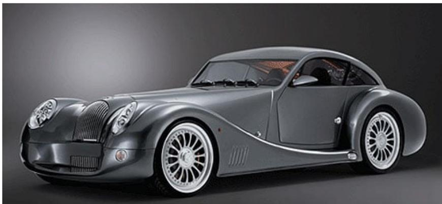
**Auf speziellen Wunsch eines Schweizer Bankiers modellierte Morgan auf Basis des Aero 8 ein elegantes Touring Coupé. Body und Chassis des Aeromax wurden aus Aluminium gefertigt und bergen im Innern einen BMW-Achtzylinder der neusten Generation. Die Vorstellung des neuen Coupés erfolgt in diesen Tagen in Genf.**
