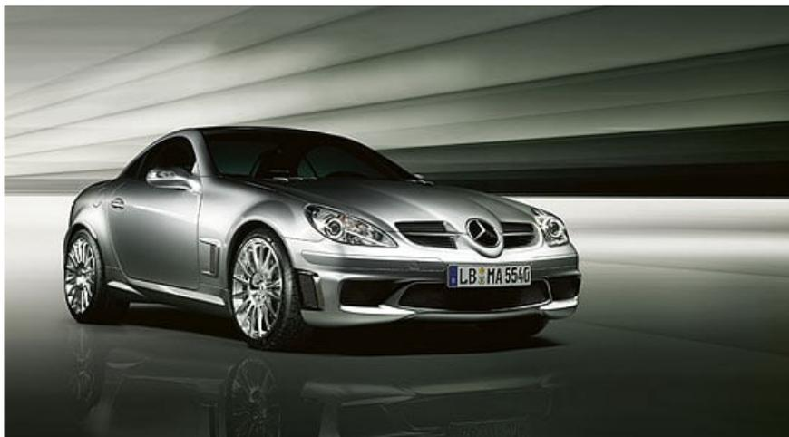
**Ab Juli legt Mercedes-Benz eine Leichtbauversion des SLK 55 AMG nach. Dank einer Gewichtersparnis von 45 Kilogramm und dem auf 400 PS leistungsgesteigerten V8-Motor verkürzen sich die Sprintzeiten um einige Zehntelsekunden. Gleichzeitig konnten die Kurvengeschwindigkeiten durch eine rennsporttaugliche Karosserie- und Fahrwerksauslegung nochmals gesteigert werden.**
