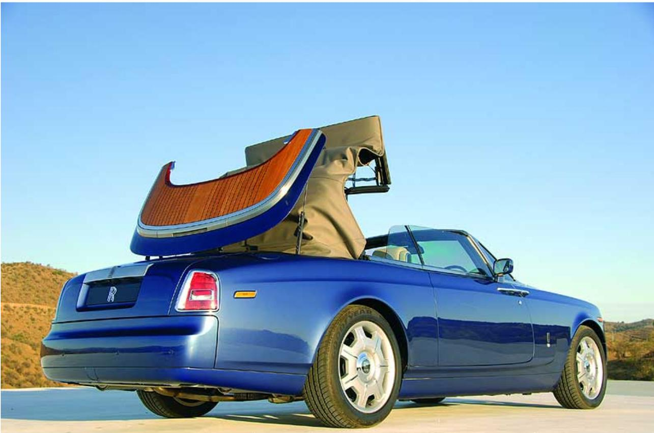
Unter der Hülle des Cabriolets verbirgt sich eine um 25 Zentimeter verkürzte Version des Phantom-Chassis. Auch das Luftfahrwerk und der kraftvolle V12-Antrieb stammen von der Limousine. Der 460 PS starke 6,75-Liter-Motor treibt das 2.620 Kilogramm schwere Drophead Coupé in unter sechs Sekunden von Null auf 100 km/h.
