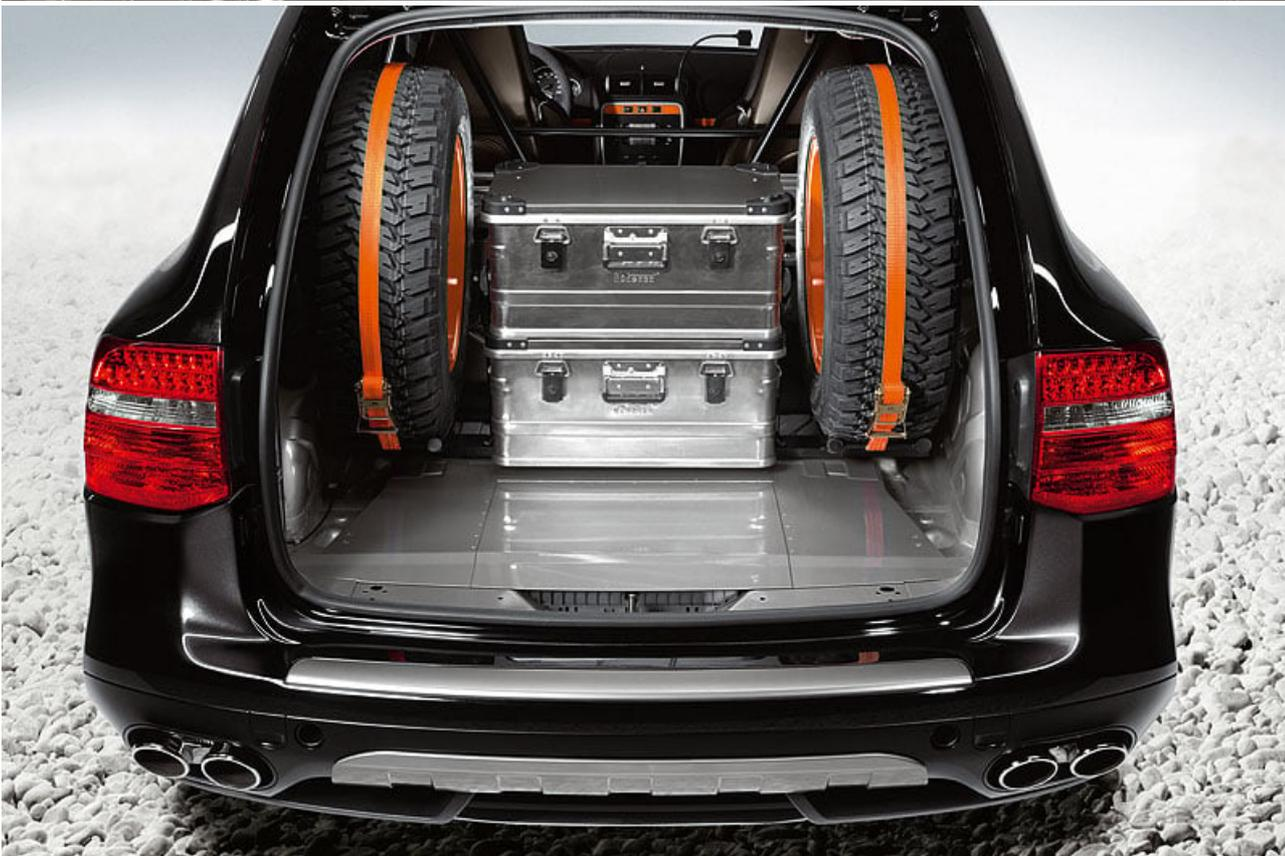
Die Fahrgastzelle des Offroaders wird von einem massiven Sicherheitskäfig geschützt. Für das umfangreiche on-board Equipment, wie Reservekanister und -räder, Transportboxen, Zelte, Klappspaten und vieles mehr, musste die Rücksitzbank weichen. Anstelle des Handschuhfaches wurde ein Tripmaster-Computer installiert, der dem Co-Piloten bei der Ermittlung der Wegstrecken zwischen einzelnen Navigationspunkten hilft.
