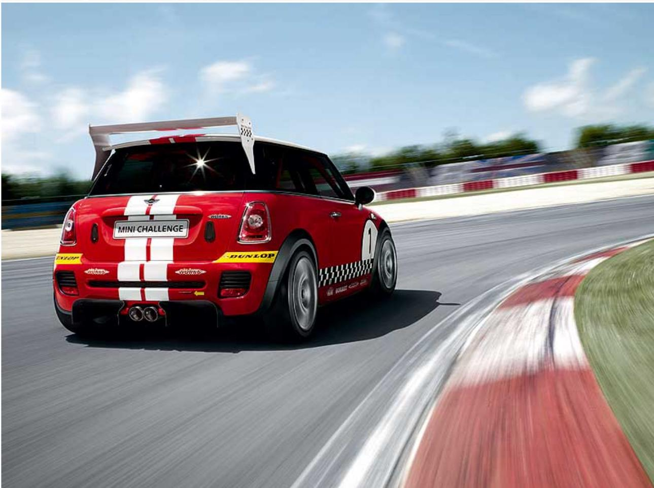
Der kleine Flitzer beschleunigt in 6,1 Sekunden von null auf 100 km/h. Im Gegenzug genügen – dank einer speziellen Rennsport-Bremsanlage – 3,1 Sekunden, um aus diesem Tempo wieder zum Stehen zu kommen. Als Höchstgeschwindigkeit erreicht das neue Rennfahrzeug 240 km/h.
