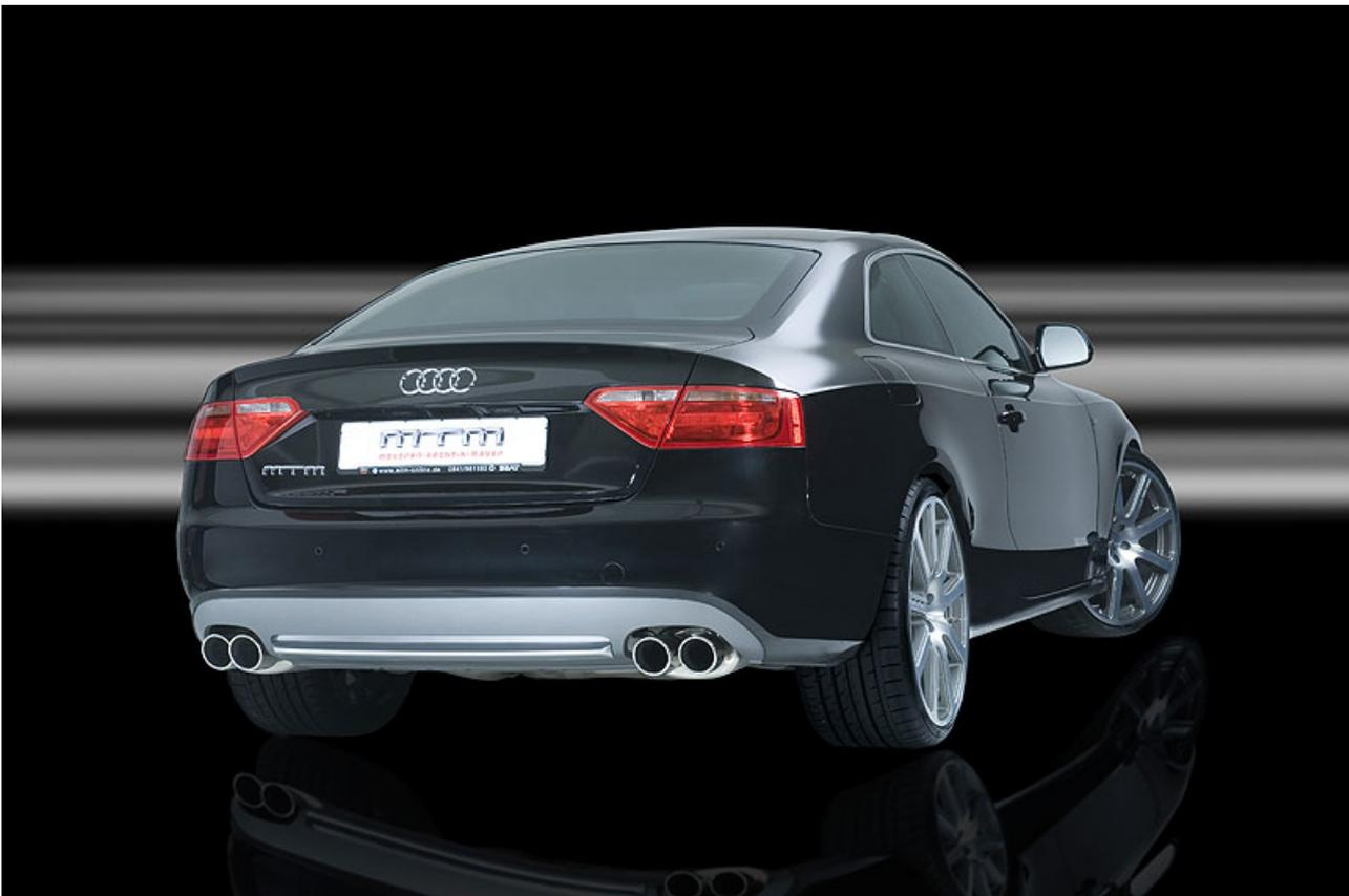
Die Leistungs-Kur des V6 TDI-Aggregats meistert MTM ohne tiefe Eingriffe – sie beruht in erster Linie auf einem neu programmierten Motorsteuergerät. Das allein bewirkt eine Gesamtleistung von 292 PS. In Verbindung mit der MTM-Vierrohr-Abgasanlage resultieren runde 300 PS. Eingriff in die Elektronik macht MTM auch bei der Aufhebung der Geschwindigkeitsbegrenzung – statt 250 erreicht der Audi A5 von MTM ganze 265 km/h.
