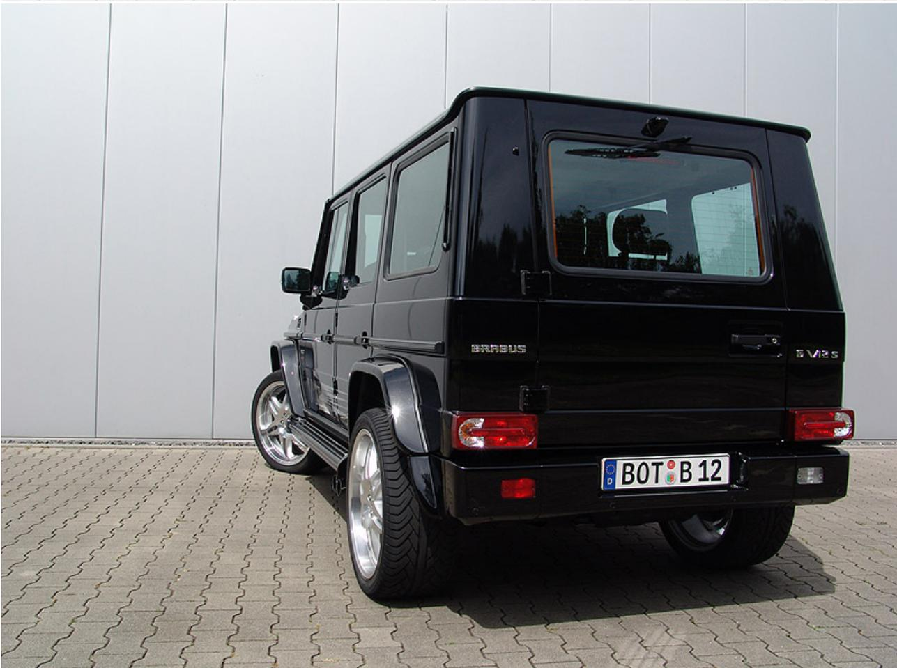
Alleine Leistung und Kultiviertheit des Gs haben sich in den Jahren immer ein Stück weiter entwickelt. Mittlerweile fahren G-Klasse Geländewagen mit dem Ausstattungsniveau einer [S-Klasse](#) vor. Aber immer noch mit Starrachsen, drei Differentialsperren und keinem luftgefederten Komfort-Fahrwerk oder Speedshift-Schaltung! Das sollte man wissen. Der 500 PS starke [Mercedes-Benz G 55 AMG](#) ist das hauseigene
