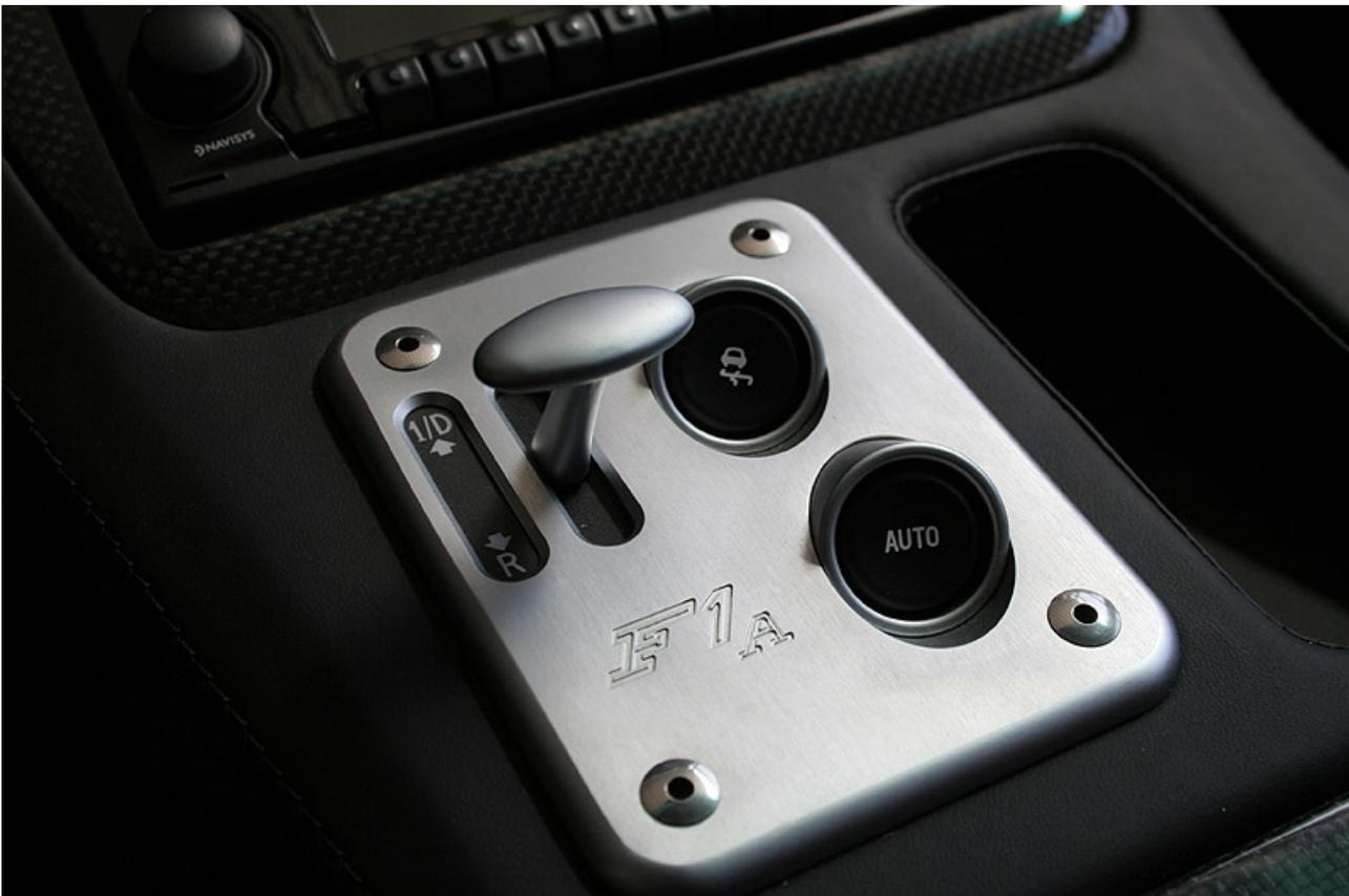
Die optionale F1 Schaltung bietet ein sequentielles 6-Gang-Schaltgetriebe, welches über Wippen hinter dem Lenkrad Formel 1 Gefühl vermittelt. Für komfortables Einparken hilft allerdings eine zusätzliche Steuerungseinheit in der Mittelkonsole zum Einlegen des Rückwärtsgangs und des ersten Gangs.
