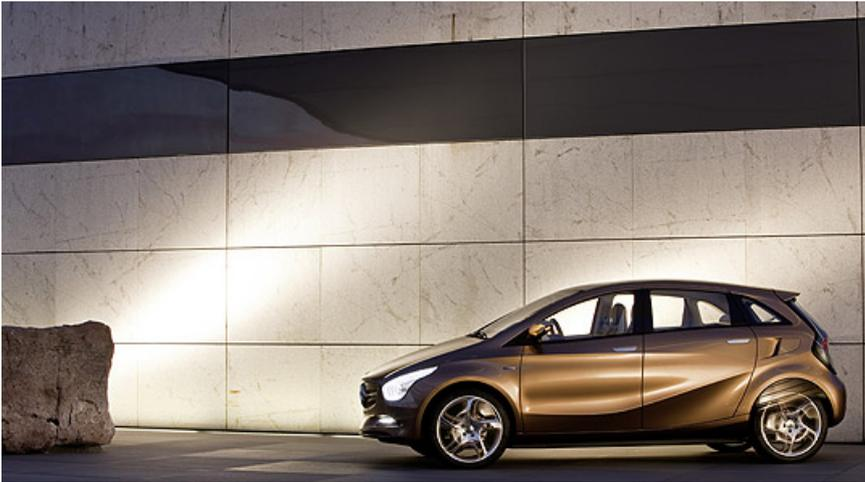
**Das Mercedes-Benz Concept BlueZero E-Cell Plus soll im emissionsfreien Elektrobetrieb über 100 Kilometer zurücklegen können und eine Gesamtreichweite von 600 Kilometer erzielen. Möglich macht dies ein benzinbetriebener Generator, der die Akkus während der Fahrt auflädt. Rein äußerlich unterscheidet sich die aktuelle Studie nicht von dem auf der Detroit Motor Show gezeigten [Mercedes-Benz Concept BlueZERO](#), wird aber als Technik-Innovation auf der IAA 2009 präsentiert.**
