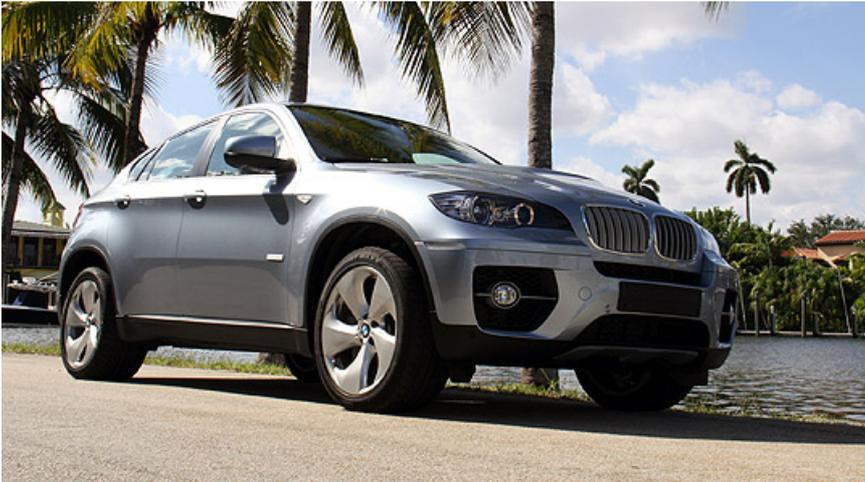
**Mit 2,5 Tonnen, 485 PS und einem cW-Wert von 0,36 ist der BMW X6 Active Hybrid alles andere als ein Ökoauto. Und dennoch: Dank zweier E-Motoren im Getriebe gelingt dem SUV der Spagat zwischen Top-Performance und zeitgemäßem Konsumverhalten.**
