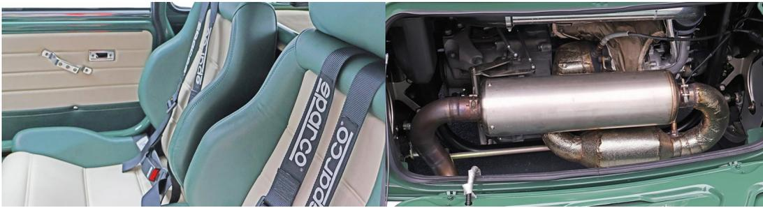
Der Meanie hat einen Reihenvierzylinder-Mittelmotor von Volkswagen mit Direkteinspritzung und einem Turbolader, beeindruckende 189 PS leistet er. Das Chassis besteht aus einem speziell entwickelten Rohrrahmen aus Chrom-Molybdän-Stahl, während die Karosserie nur ganz dezent verändert wurde - nur die schärfsten Augen erkennen, was wirklich in dem mächtigen Meanie steckt.
