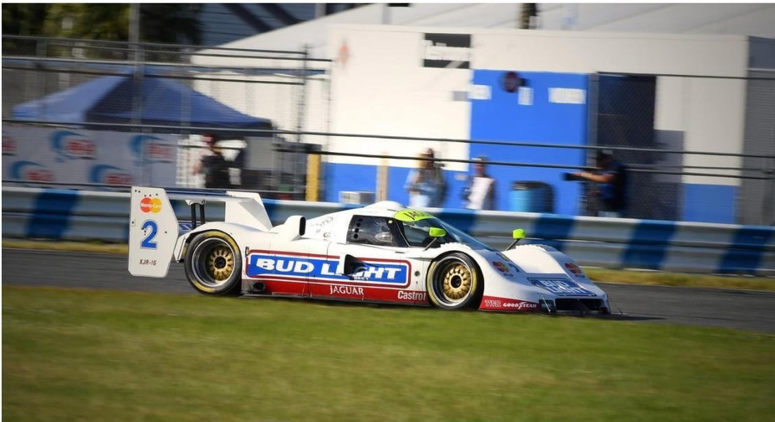
Die XJR-16 genannte, hochmoderne Großkatze, wird von einem 90-Grad-Twin-Turbo-V6-Motor angetrieben, der 750 bis 900 PS über ein TWR-Fünfgang-Schaltgetriebe an die Hinterräder schickt. Der XJR-16 sieht nicht nur gut aus und hat genug Schubkraft, um seinen optischen Eindruck zu untermauern, denn mit nur 950 Kilogramm auf der Waage überzeugt sein beeindruckendes Leistungsgewicht.
