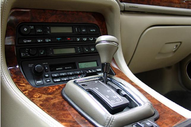
Haltbarer sind dagegen die Automatikgetriebe. Zwar bietet die anfangs eingesetzte Viergangversion nur mäßigen Schaltkomfort, kaputt geht sie indes eher selten. Das gilt auch für die ebenfalls verfügbare Fünfgangversion des Zulieferers ZF, die bis auf den sporadischen Ausfall der Kommunikation mit dem Motorsteuergerät ebenfalls störungsfrei läuft. Bei beiden Getrieben sollte jedoch peinlichst genau auf den regelmäßigen Wechsel des Getriebeöls geachtet werden.
