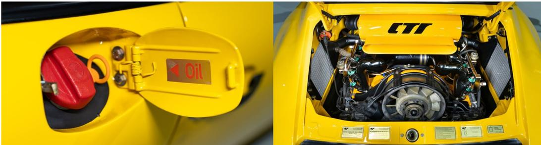
Über der Hinterachse befindet sich das pochende Herz des Yellowbird, ein von Hand montierter, 3,4-Liter großer, luftgekühlter Sechszylinder-Boxermotor samt zwei Turboladern und Ladeluftkühlern sowie einer frühen Version der ursprünglich für den Porsche 962 entwickelten Bosch Motronic-Einspritzung. Die Leistung wurde mit 463 PS bei 5.950 Umdrehungen angegeben, aber der Fahrer konnte die Lage vom Cockpit aus über einen Ladedruckregler eskalieren, wenn er den Mut dazu hatte.
