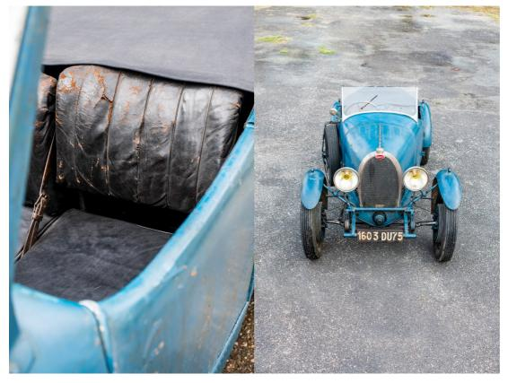
Dieses A-Modell Baujahr 1929 (Chassis 40776) wird von einem fast 1650 ccm großen Achtzylinder mit Block vom Typ 49 angetrieben. Mit Doppelzündung und gespeist von einer elektrischen Autofflux-Benzinpumpe. Dieses Exemplar gehört zu den frühesten Typ 40 A und verfügt über den äußerst seltenen "Doppelzündungsschalter" von Marchal et
