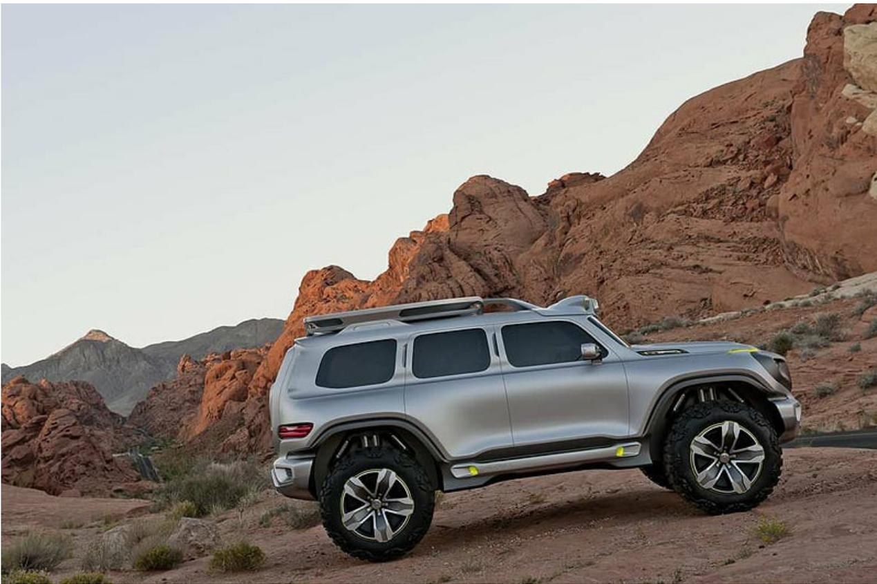
Da in Zukunft das schwindende Erdölvorkommen einen alternativen Antrieb notwendig machen wird, wurde im Ener-G-Force ein Brennstoffzellenantrieb eingebaut. Ein Hydro-Tech Converter wandelt auch auf dem Dach aufgefangenes Wasser in Wasserstoff um, welcher für den Brennstoffzellenbetrieb benutzt wird. Wasser ist zudem das Einzige, was von dem bis zu 800 Kilometer weit fahrenden Fahrzeug ausgestoßen wird. Letztendlich kommt die so gewonnene Energie den vier Radnabenmotoren zu Gute.
