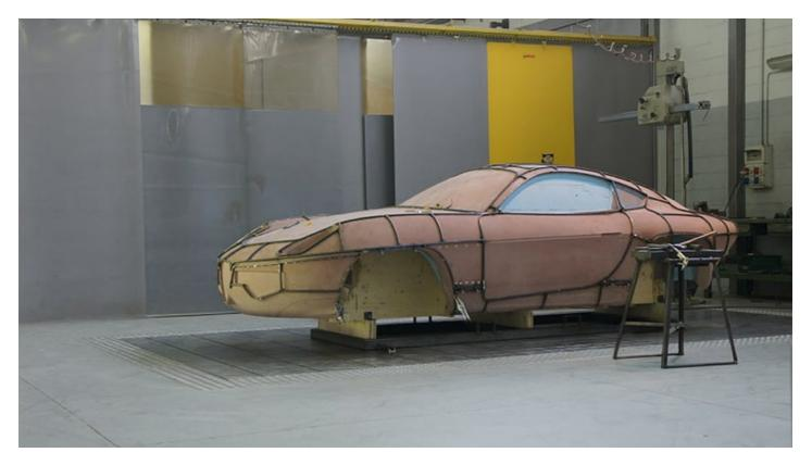
Dann kommt der Zeitpunkt für den Referenzkäfig – eine Gitterkonstruktion aus weichem Stahl, die präzise um die Konturen des Baumharz-Modells herum verschweist wird. Im Anschluss wird der Käfig als Anleitung für die Verbindung des Chassis mit allen vohandenen und neuen Teilen aus Aluminium, Carbon und Glas. Die Anpassung der Karosserie und die folgenden Schritte präsentieren wir Ihnen in der nächsten Folge.
