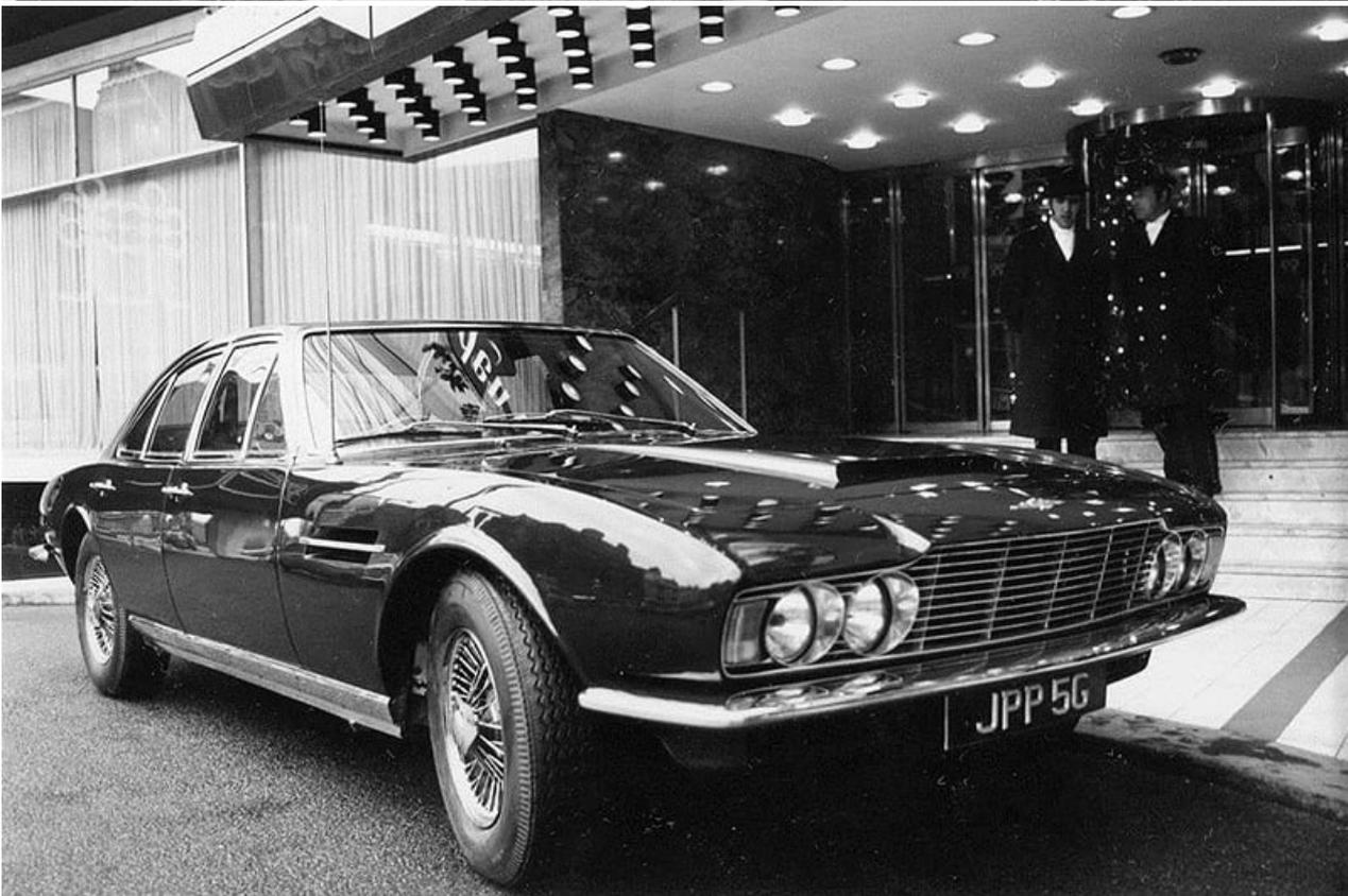
Der Radstand wurde verlängert und die Dachlinie neu gezogen. Der Abgang zum Heck setzte nun deutlich weiter hinten an. Das gab den Gästen in der zweiten Reihe erkennbar mehr Kopffreiheit - über sechs Zentimeter. Und das mit einem Schiebedach, welches bei Öffnung unter den Innenhimmel glitt. Das Reserverad wurde flach unter dem Boden des Kofferraums gelagert, dessen Klappe nun tief zwischen den Heckleuchten abschloss. Genug Platz für Picknick-Equipment, Golfschläger oder Jagdutensilien.
