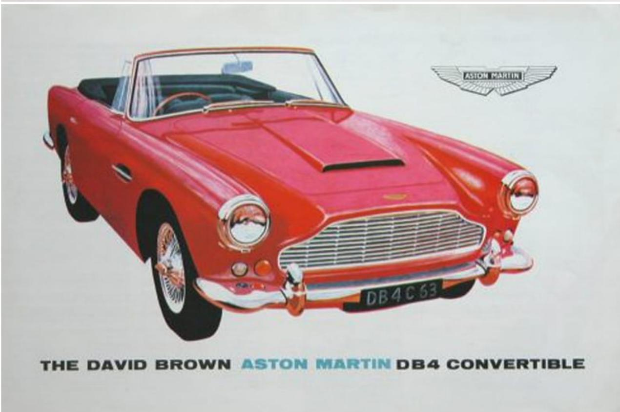
Touring sollte nicht nur das Styling übernehmen, sondern auch die notwendigen Werkzeuge und Maschinen für den Aufbau des DB4 in Newport Pagnell bereitstellen. Denn die Spezialität der Italiener war das „Superleggera“ genannte Leichtbau-Konzept aus Stahlrohren, auf denen dann die Aluminiumpanele des Autos montiert wurden.
