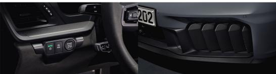
Infolge dieser vereinfachten Beleuchtungs-Konfiguration konnte Porsche beim 911 die Fronteinlässe vergrößern – die Version für den GTS besitzt fünf vertikal angeordnete aktive Kühlungsklappen, die mit den adaptiven Frontdiffusoren am Unterboden agieren. Im Innenraum entdeckt man als Premiere in einem 911 erstmals einen Starterknopf, wie auch die Instrumenteneinheit erstmals komplett digital ausgeführt ist und – leider – auf den wunderschönen analogen Drehzahlmesser des 992.1 verzichtet.
