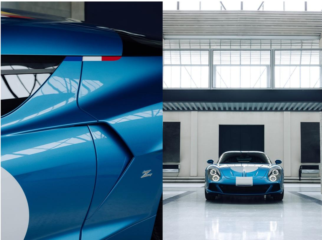
Der große Kniff des fast vollständig aus Kohlefaser gefertigten AGTZ Twin Tail liegt daher auch in seiner Verwandlungskunst. Denn das so leicht wie möglich geformte Heck lässt sich bei Bedarf abnehmen oder wieder anbringen, wodurch sich die Länge von 4802 auf 4305 Millimeter reduziert (und umgekehrt). Gleichzeitig bleibt das Gesamtgewicht eng am Niveau des Spenderfahrzeugs.
