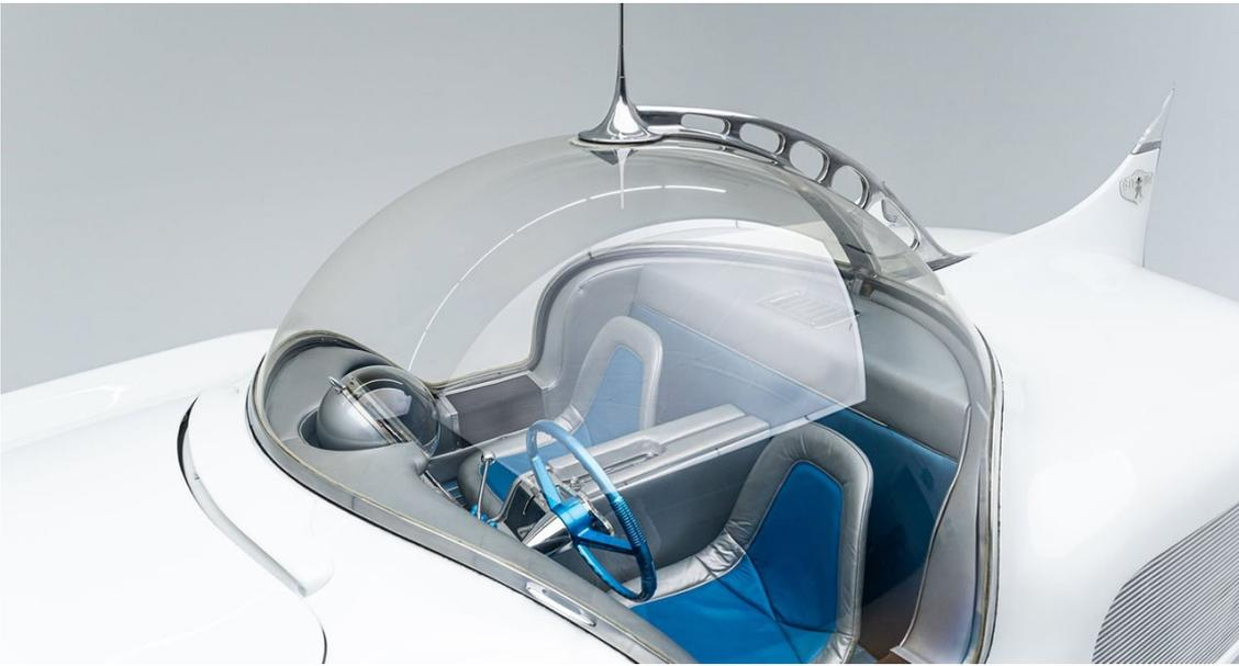
Arbib entwarf nämlich ein Kampffjet-ähnliches Plexiglasdach, das über einen auf einen Aluminiumarm wirkenden Elektromotor auf Knopfdruck angehoben und wieder abgesenkt werden konnte. Im geöffneten Zustand konnten Fahrer und Beifahrer über die erwähnten Trittstufen ein- und aussteigen. Das Glashaub bot nicht nur eine exzellente Rundumsicht, sondern vermittelte bei voll aufgedrehter Klimaanlage wahrscheinlich den Eindruck, in einem Cabrio zu fahren.
