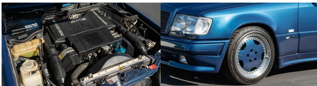
Dann verbreiterte AMG die Karosserie des neuen 6,0-Liter-Kraftwerks, unter anderem mit stark auskragenden Kotflügeln, um die ebenfalls breiteren dreiteiligen OZ AMG Aero III-17-Zoll-Räder unterzubringen, die zusammen mit dem Sperrdifferential diese beachtliche Power auf die Straße brachten. Diese komplett neu konzipierte Bestie zeigt nur 36.701 Kilometer auf Uhr und wird auf 705.882 - 800.000 Euro geschätzt. Ja, Sie haben ganz richtig gelesen.
