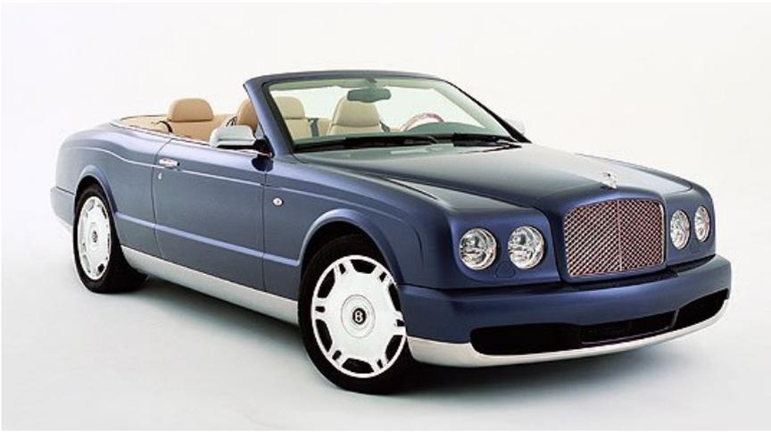
Eine extrem steife Karosserie, Doppelquerlenker-Einzelradaufhängung und der V8-Twinturbo-Motor bilden die Plattform für das Drophead Coupé. Angetrieben von einer 457 PS starken Version des 6,75-Liter-V8-Twinturbo-Motors liefert das Cabriolet ein maximales Drehmoment von 875 Nm.
